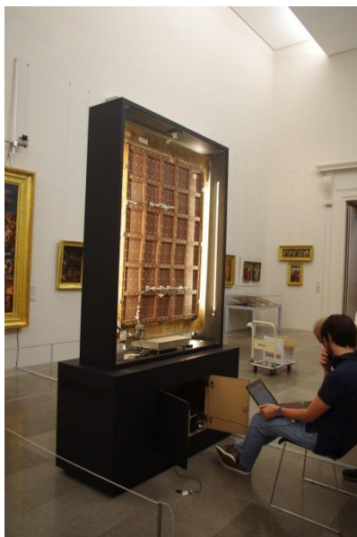
Vérification des mesures enregistrées par les trois Kits Déformométriques sur l'ordinateur dédié au projet (fourni par DELL), par Lorenzo Riparbelli (GESAAF) et Luca Uzielli (GESAAF)
