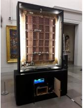
Chambre climatique hygrorégulée Suivi de variation de masse à l'aide d'une balance Stéréo-corrélation par suivi de marqueurs sur les 2 faces simultanément Mesures locales de courbure et déformation à l'aide de 3 kits déformométriques
