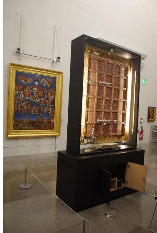
L'œuvre « équipée » est installée dans une chambre climatique, posée sur une balance qui permet de mesurer les variations de masse, se trouvant dans la salle du Jeu de Paume.
