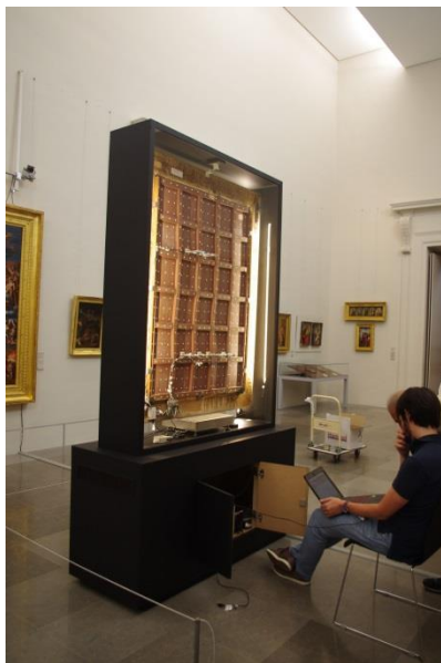
Vérification des mesures enregistrées par les trois kits déformo-métriques sur l'ordinateur dédié au projet, par Lorenzo Riparbelli (GESAAF) et Lucas Uzielli (GESAAF)
